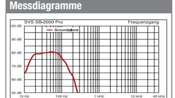
**Frequenzgang & Impedanzverlauf**
