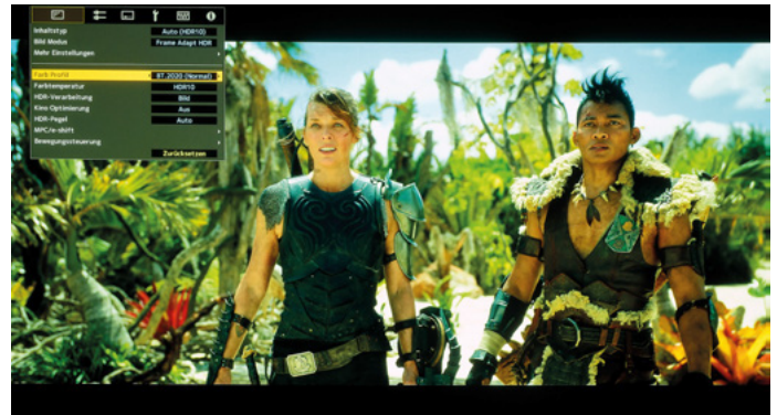
Mit dem kleineren Farbraum „BT2020 (Normal)“ nimmt die Lichtausbeute auf 2.210 Lumen zu. Farben bleiben ähnlich, dunkle Inhalte erhalten aber mehr Zeichnung.
