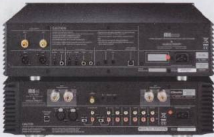
Der Player hat auch als Wandler seine Qualitäten und verfügt über vier Eingänge.
