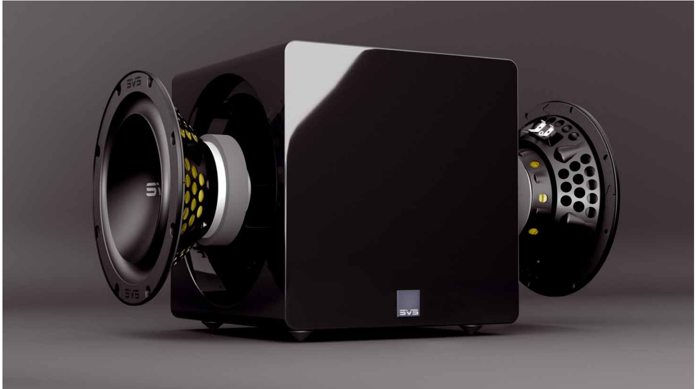
Der 3000 Micro arbeitet mit zwei gegenüberliegenden 8-Zoll-Treibern, die mit kräftigen Antrieben und stabilen Aluminiummembranen ausgestattet sind
