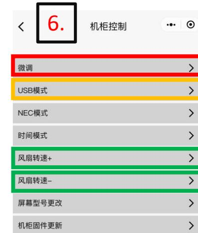
In rot geht es zur Justierung der Schublade, in Orange wird der USB Modus angeschaltet für automatisches Herausfahren beim Anschalten des Laser TVs (dazu bitte den USB Stecker aus dem Kabelbaum an einen USB Port im Projektor einstecken), in Grün kann ich die Lüfter regeln mit Plus und Minus
