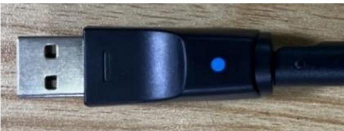
*Abbildung 1 - RF-Antenne. Beachten Sie den blauen Punkt, der die Kompatibilität mit der RC2-Fernbedienung anzeigt.*
