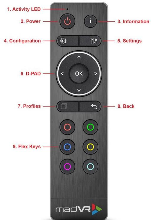
Abbildung 3 - Anordnung der RC2-Tasten.
